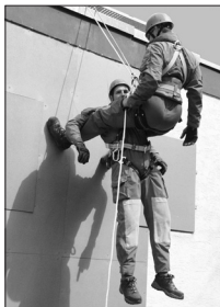
Παράδειγμα: Εκκένωση χρησιμοποιώντας τη συσκευή κατάβασης Milan.
